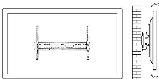
Nyní můžete nastavit úhel TV zatlačením za horní a zatažením za spodní hranu TV nebo naopak.
