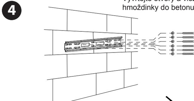
Přišroubujte závěsnou desku ke stěně pomocí dodaných kotevnic šroubů (A) a kotevnic podložek (C)
