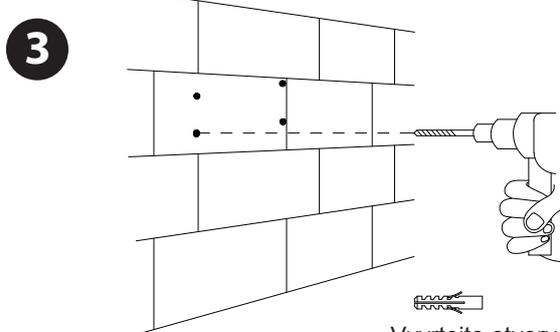
Vyvrtejte otvory a vložte do nich hmoždinky do betonu (B)
