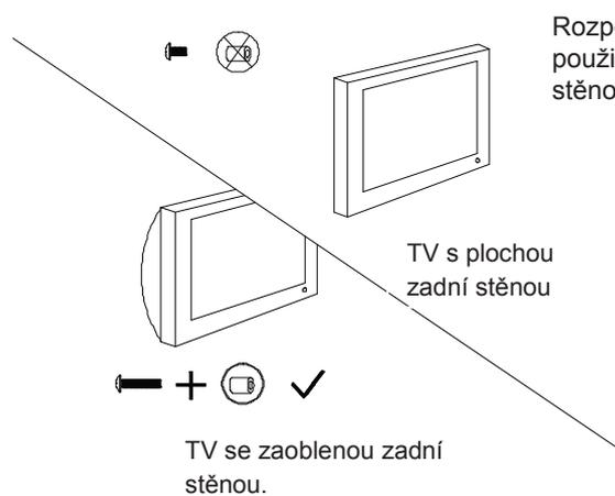
Rozpěrné podložky jsou vhodné zejména pro použití s TV s vypouklou a jinak netypickou zadní stěnou.
