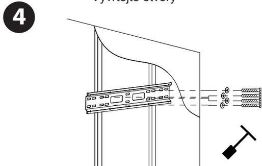
Přišroubujte závěsnou desku ke stěně pomocí dodaných kotevnic šroubů (A) a kotevnic podložek (C).
