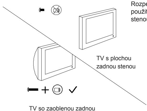
Rozperné podložky sú vhodné najmä na použitie s TV s vypuklou a inak netypickou zadnou stenou.
