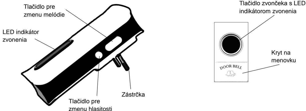
**Poznámka:** Zvonček pracuje na frekvencii 433,92MHz. Dosah je max. 80m v otvorenom priestranstve. Batéria do vysielča je alkalická 12V/23A (LR23A). LED dióda na prijímači svieti počas zvonenia. V určitých prípadoch je možné používať tento zvonček osobami so sluchovými poruchami.
