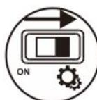
1. Prepnite prepínač režimov do polohy ozubeného kola. LED dióda sa rozsvieti.
