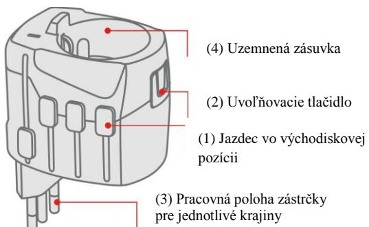
Pred použitím presuňte všetkých postranných jazdcov späť do východiskových pozícii (1). Stlačte uvoľňovacie tlačidlo (2) a posúvajte vybraným jazdcom smerom dopredu, pokiaľ nezavakne v pracovnej polohe (3). Zasuňte zástrčku elektrického prístroja do zásuvky adaptéra (4). Zasuňte adaptér do sieťovej zásuvky (5). Pri odpojovaní postupujte opačným spôsobom.
